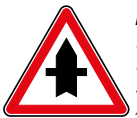
AB2 Intersection avec une route dont les usagers doivent céder le passage dans le cas où un panneau AB6 ne peut être utilisé.
