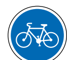
B22a Piste ou bande cyclable obligatoire pour les cycles sans side-car ou remorque.
